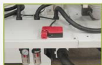
安全锁 Safety Lock
